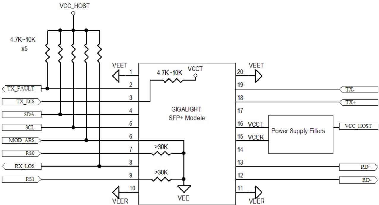
Figure4. Host-Module Interface
